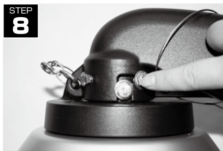
STEP 8 落下防止用の 1/4-20UNC ビスを L 字の溝にまず取 付後、その他のビスを均一の強さで締め固定します。
